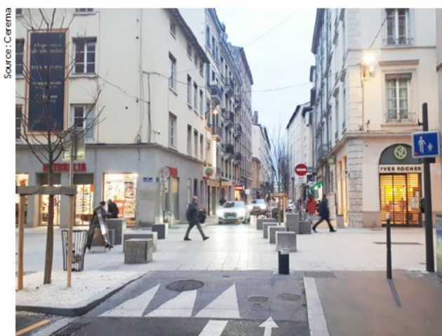
À Lyon, la rue piétonne Victor Hugo a été réaménagée en 2020. Le revêtement du plateau piétonnier est continu à chaque intersection
