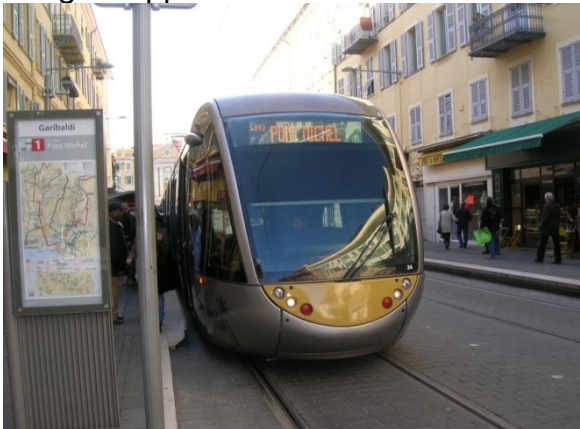
Nice : Arrêt Garibaldi, baisse du pantographe pour franchissement de la Place sur batteries.
